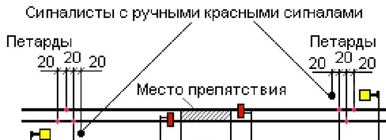
**Указать протяженность места производства работ для схемы ограждения**
